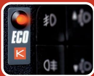
Con el led encendido la potencia del motor está reducida.
